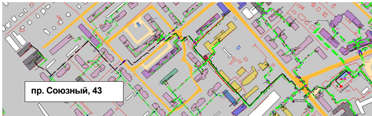
Рисунок 0.75 – Результат гидравлического расчета - расчетный путь теплоносителя от котельной пр. Союзный, 43 до ПТ-Комин, 256 э2
