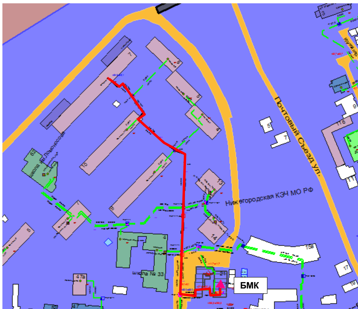
Рисунок 0.93 – Результат гидравлического расчета - расчетный путь теплоносителя от котельной Суетинская, 21 до ПТ-Федор,7
