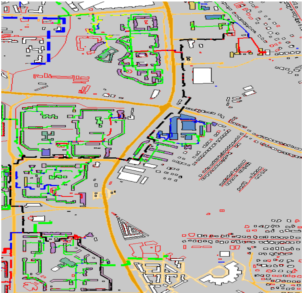
Рисунок 0.135 – Результат гидравлического расчета - расчетный путь теплоносителя от котельной ул. Родионова, 1946 до ПТ-Богдан.1 пр.
