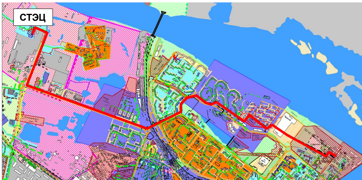
Рисунок 0.85 - Результат гидравлического расчета - расчетный путь теплоносителя от СТЭЦ до ПТ-ПП-2.64-2017
